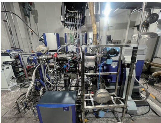
图 2 氨柴发动机试验台架实物图
